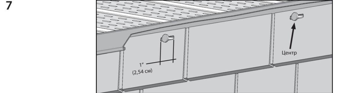
Если нужно закрепить секцию не через монтажное отверстие, прорежьте отверстие диаметром 1" (2,54 см), чтобы в него можно было забить гвоздь. Забивать гвоздь всегда нужно строго в середине отверстия.
