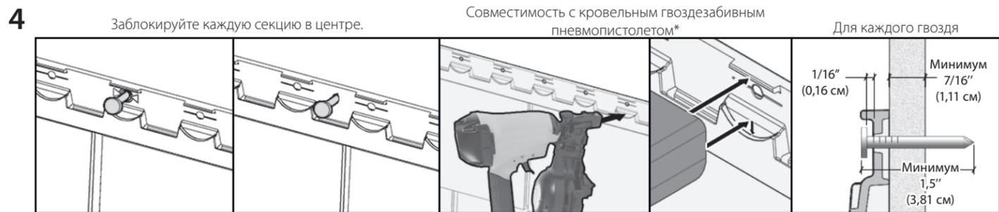
При монтаже целой секции сначала забейте гвоздь в центральное отверстие. При монтаже обрезанной секции закрепите ее центр гвоздем, как показано. Для каждого гвоздя оставьте зазор между шляпкой и секцией. При использовании кровельного гвоздезабивного пневмопистолета отрегулируйте его наконечник на самой высокой позиции и выберите давление в соответствии с основой, чтобы получить нужный зазор.
