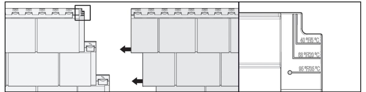
При температуре ниже 40 °F (5 °C) размещайте секцию, слегка сдвинув ее вправо (1/16" (0,16 см)) относительно температурной отметки для 40 °F (5 °C).
