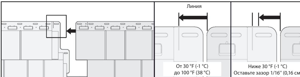
При температуре ниже 30 °F (-1 °C) слегка сдвиньте секцию вправо (1/16" (0,16 см)) относительно ограничителя.
