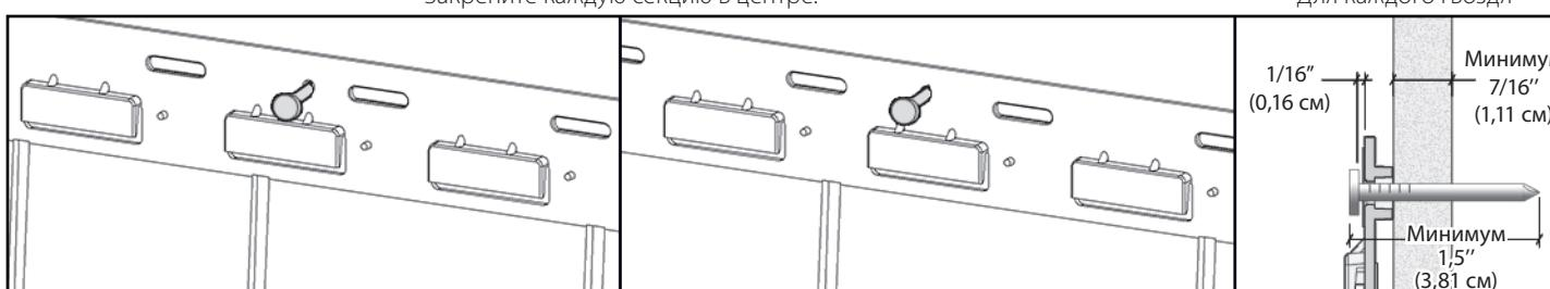
При монтаже целой секции сначала забейте гвоздь в центральное отверстие.
