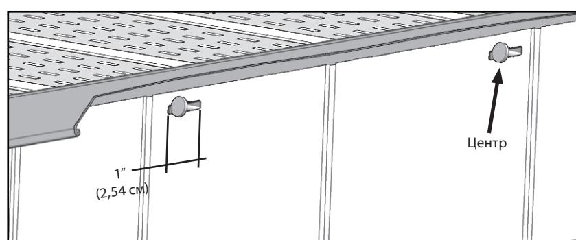
Если нужно закрепить секцию не через монтажное отверстие, прорежьте отверстие диаметром 1" (2,54 см), чтобы в него можно было забить гвоздь. Забивать гвоздь всегда нужно строго в середине отверстия.
