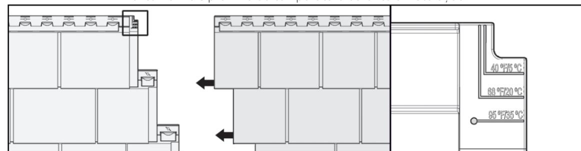
Abaixo de 40 °F (5 °C), posicione a seção ligeiramente à direita (1/16", ou 0,16 cm) da linha de temperatura 40 °F (5 °C).
