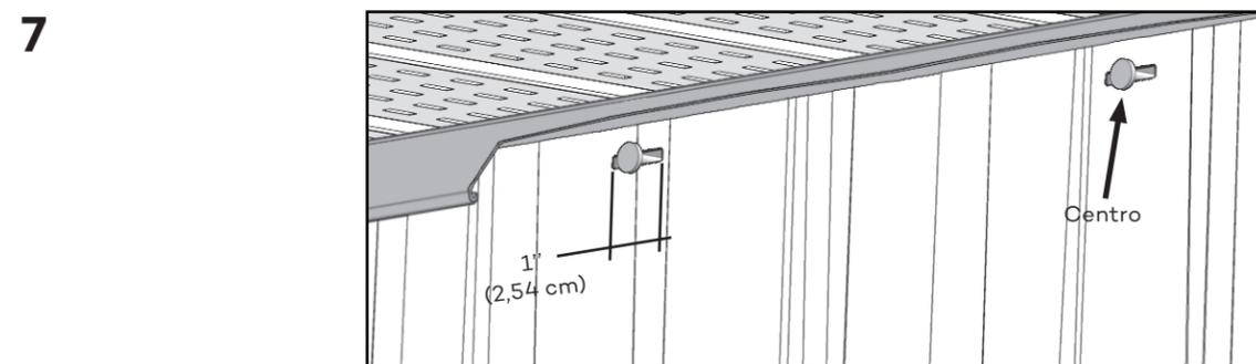
Se precisar fixar a seção em uma área diferente do furo de instalação, crie uma abertura de 1" (2,54 cm) para permitir a entrada do prego. Sempre coloque o prego no meio da abertura.
