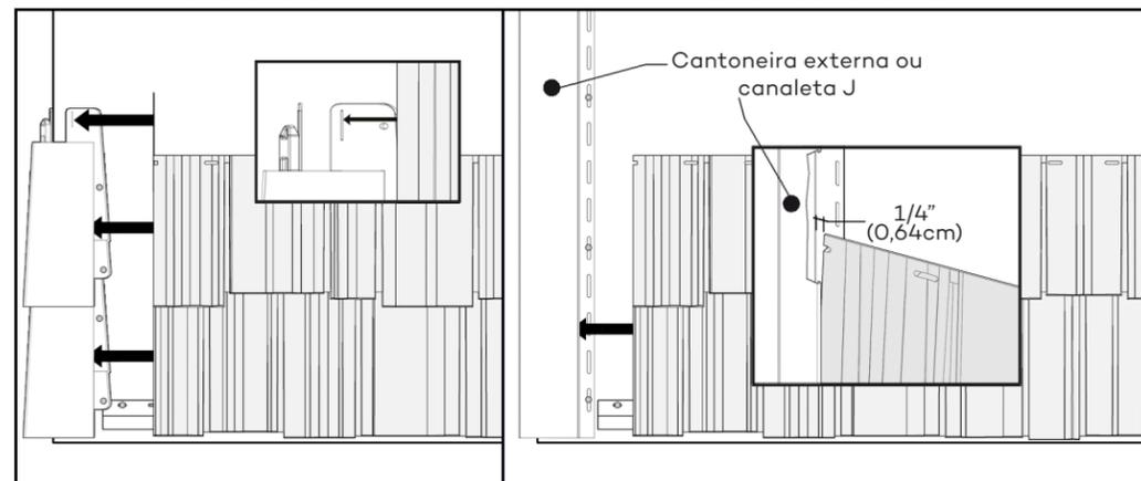
3 Para seção com comprimento total.
