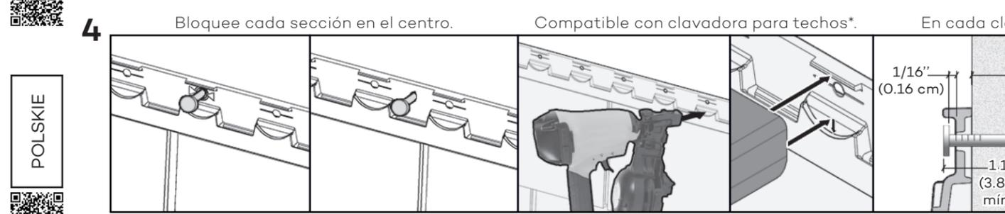
Cuando se instale una sección completa, clave primero el orificio central. Cuando instale una sección cortada, clave el centro como se muestra. En cada clavo, deje un espacio entre la cabeza del clavo y la sección. Cuando use una clavadora para techos, ajuste la punta a su posición más alta y la presión del aire según el sustrato a fin de dejar el espacio requerido.
