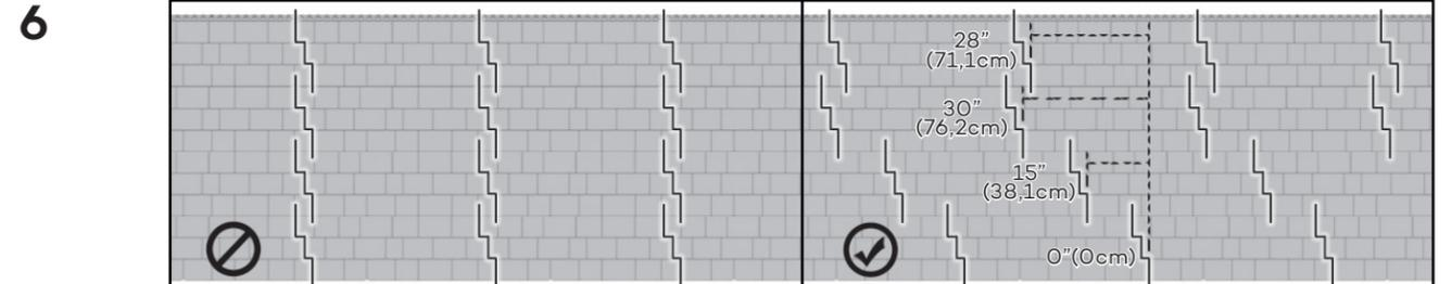
Alternar los joints entre las rangées. Pour une meilleure apparence, nous suggérons d'alternar la distance de coupe de la première section de chaque rangée entre 0"(0cm) - 15"(38,1cm) - 30"(76,2cm) - 28"(71,1cm).
