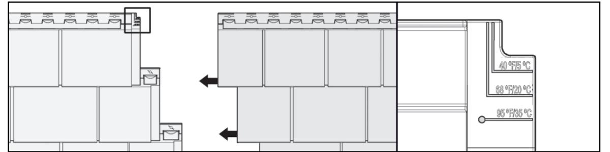
Pour des température inférieure à 40°F(5°C), positionner la section légèrement à droite (1/16"(0,16cm) de la ligne de température 40°F(5°C).
