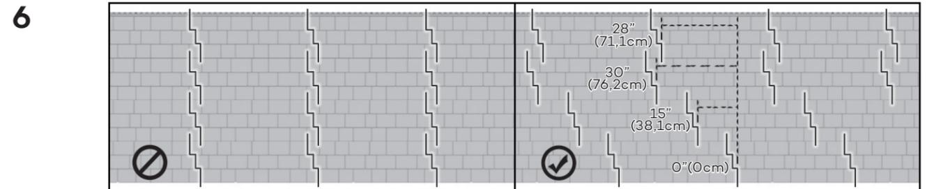
Alternar les joints entre les rangées. Pour une meilleure apparence, nous suggérons d'alternar la distance de coupe de la première section de chaque rangée entre 0"(0cm) - 15"(38,1cm) - 30"(76,2cm) - 28"(71,1cm).
