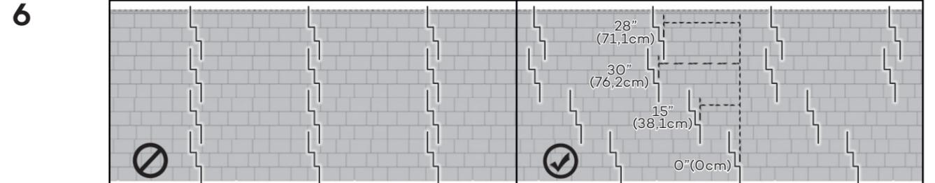
Alternar les joints entre les rangées. Pour une meilleure apparence, nous suggérons d'alternar la distance de coupe de la première section de chaque rangée entre 0"(0cm) - 15"(38,1cm) - 30"(76,2cm) - 28"(71,1cm).
