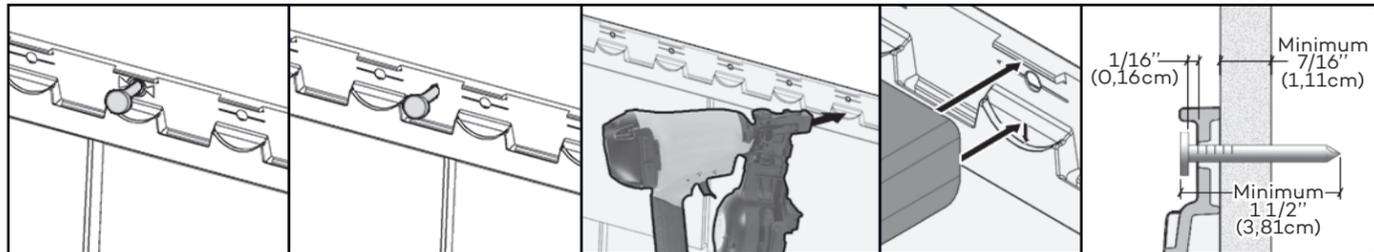
Lors d'utilisation d'une section complète, fixer dans le trou central d'abord. Lors d'utilisation d'un section coupée, fixer en son centre tel qu'illustré. Pour chaque clou, laisser un espace entre la tête du clou et la section. Lors de l'utilisation d'une cloueuse pneumatique, ajuster l'embout à la plus haute position ainsi que la pression d'air selon le substrat afin de laisser l'écart nécessaire.
