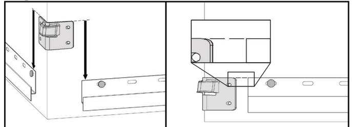
2-Insérer le premier coin dans l'ouverture de l'agrafe de départ en couvrant les panneaux de la première rangée (#1, Figure H) et glisser le haut du coin sous les panneaux de la 2e rangée. Ajuster sa hauteur selon les bardeaux de chaque côté et fixer une attache dans chaque trou d'installation du coin.
