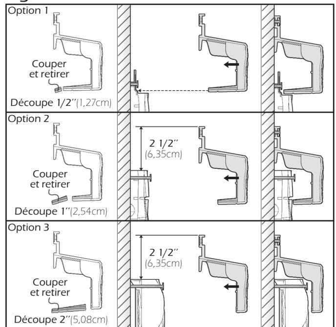
2-Avant de faire des coupes, il est suggéré de planifier d'abord le positionnement des moulures sur le mur. Mesurer la longueur du mur à couvrir entre les Coins Moulure Architecturale ou les Abouts Moulure Architecturale. Diviser par 30" (76,2cm) et répartir la coupe sur la première et dernière moulure afin d'avoir des longueurs égales sur le mur (Figure E).
