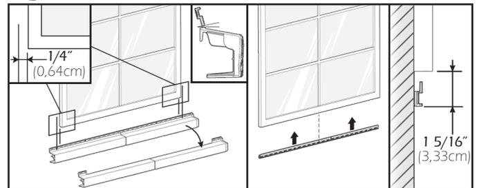
2-Installer le revêtement sous la fenêtre tel que spécifié dans son guide d'installation en s'assurant de laisser une distance de 1/4" (0,64cm) sous les têtes de clouage (Figure J).
